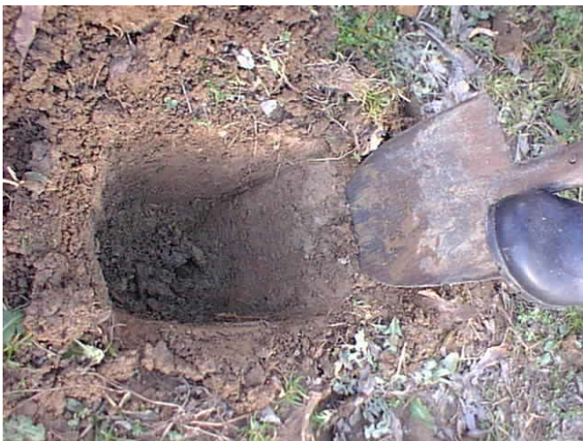
5. Poravnati čeonu stranu i po čitavoj dubini zasjeći sloj zemljišta debljine 2 – 5 cm
