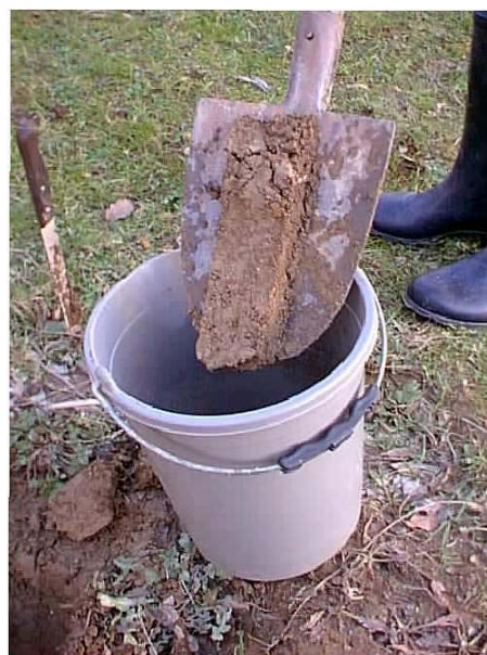
8. Srednji sloj zemljišta ubaciti u kantu. Ova količina predstavlja pojedinačni uzorak
