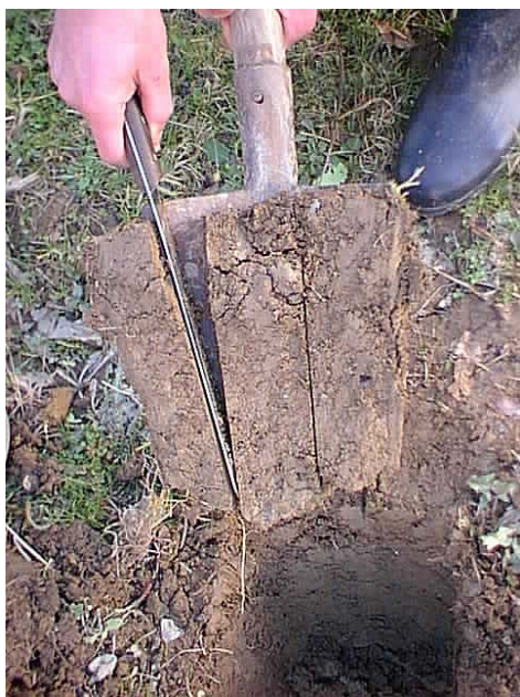
7. Nožem odsjeći i odbaciti višak zemljišta sa obe strane radnog dijela ašova
