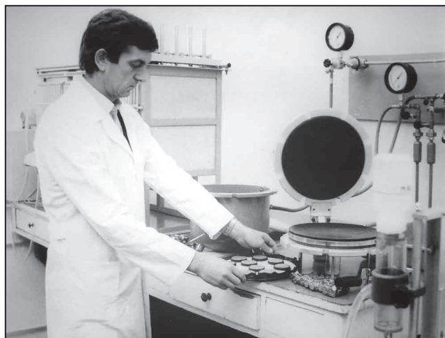
Слика 32. Одређивање пропусности земљишта за воду, Раде Лукић, дипл. инж. 1980. године
